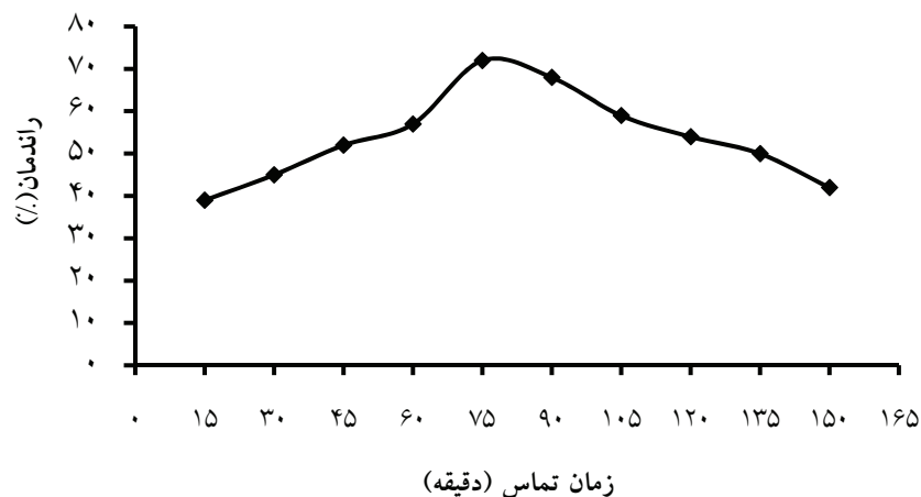
شکل ۳: درصد حذف COD در زمان تماس های مختلف (شرایط آزمایش: H_2O_2/Fe^{2+} = Fixed و pH = ۳)
