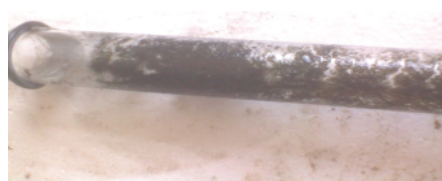
شکل ۶: نمایی از رسوب تشکیل شده بر سطح کوارتز لامپ های فشار متوسط و کم فشار UV
