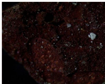
شکل ۱: تصاویر دانه‌های زئولیت با نانوذرات اکسید مس (الف) و زئولیت بدون نانو ذره (ب)، (بزرگ‌نمایی ۱۰۰)
