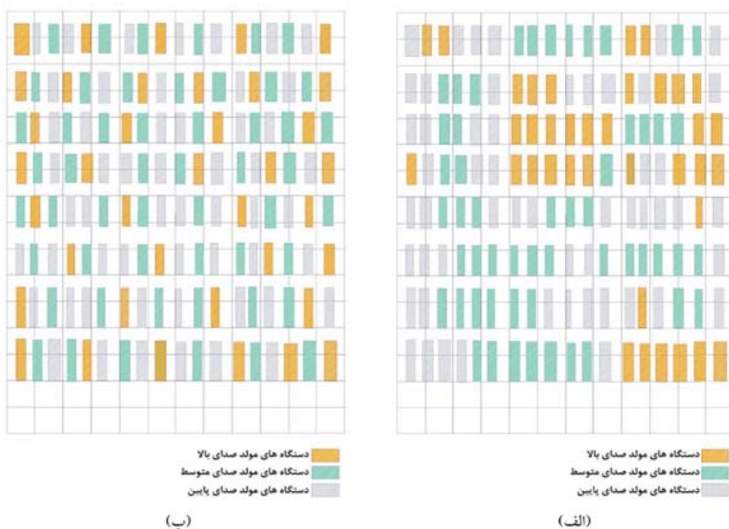
شکل ۸- الف) جانمایی اولیه دستگاه‌های بافندگی، ب) جانمایی بهینه و متعادل دستگاه‌ها براساس تولید صوت
