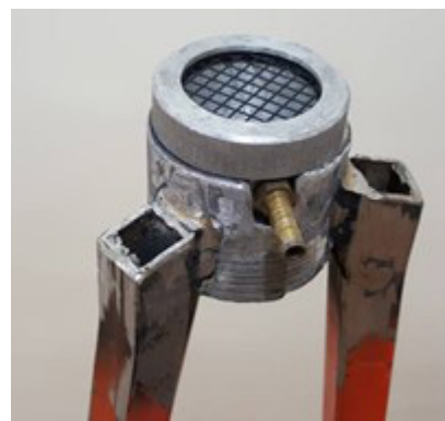
شکل ۱- پایه طراحی شده و فیلتر جهت نمونه‌گیری از ذرات گرد و غبار به مدت 6 h
