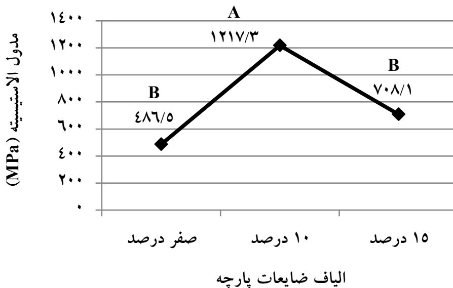
نمودار ۲- اثر استفاده از الیاف ضایعات پارچه بر مدول الاستیسیته تخته فیبرهای ساخته شده
