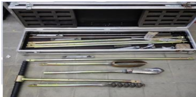
شکل ۲- دستگاه اوگر (Auger) برای نمونه برداری از عمق های مختلف از محل دپوی لجن
