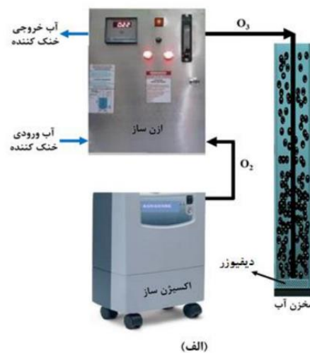
شکل ۱- شماتیک فرایند ازن زنی (الف) و فیلتراسیون غشایی (ب)
