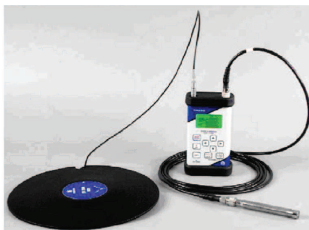
شکل ۱: نمایی از دستگاه ارتعاش سنج مدل SVAN 958
