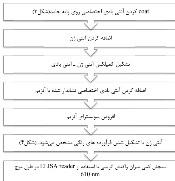
شکل ۲- مراحل کلی سنجش نشانگرهای زیستی با استفاده از روش ELISA (Enzyme-linked immunosorbent assay)
