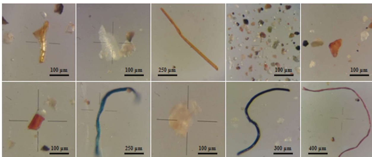
شکل ۲- نمونه‌هایی از میکروپلاستیک‌های شناسایی شده با استریو میکروسکوپ
