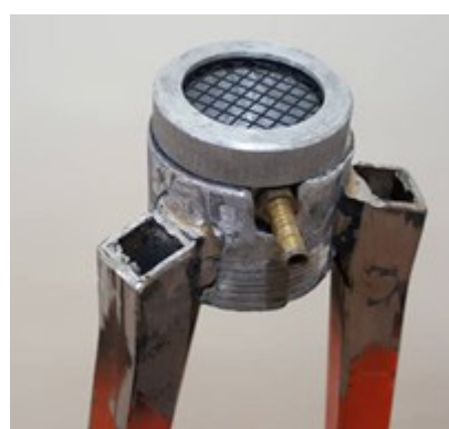
شکل ۱- پایه طراحی شده و فیلتر جهت نمونه‌گیری از ذرات گرد و غبار به مدت ۶ h
