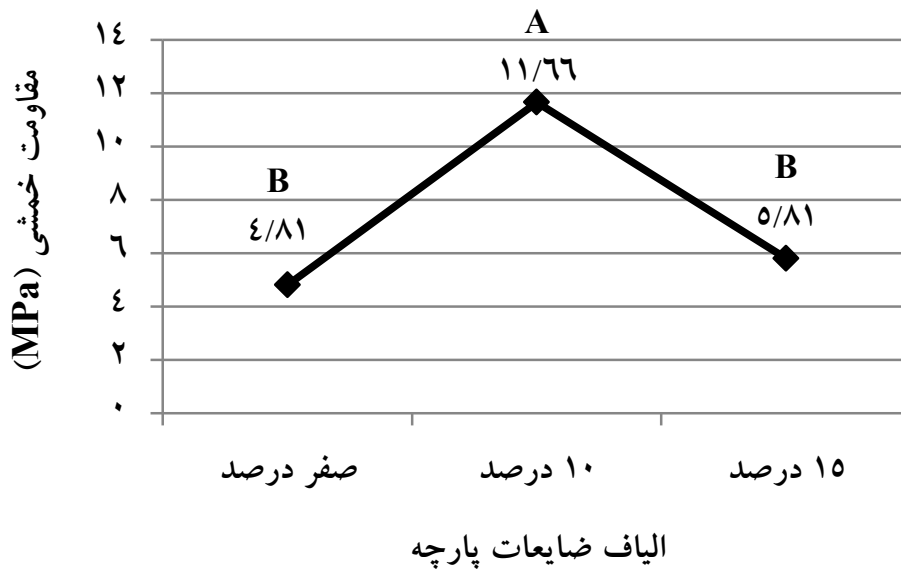
نمودار ۱- اثر استفاده از الیاف ضایعات پارچه بر مقاومت خمشی تخته فیبرهای ساخته شده
