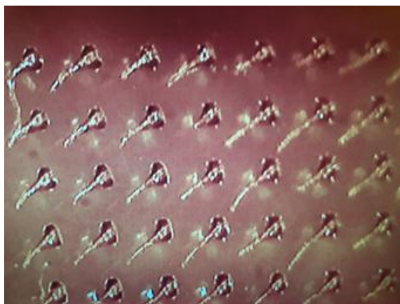
شکل ۵: تشکیل سوزن‌های مخروطی با هندسه ناپایدار و نسبت ابعاد نامناسب به علت نامتناسب بودن زمان نوردهی که باعث شده است شکل هندسی ایجاد شده با طرح اولیه بسیار متفاوت باشد.
