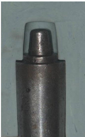
شکل ۵- ایندکس تهیه شده برای یکنواخت سازی پرسن گذاری
