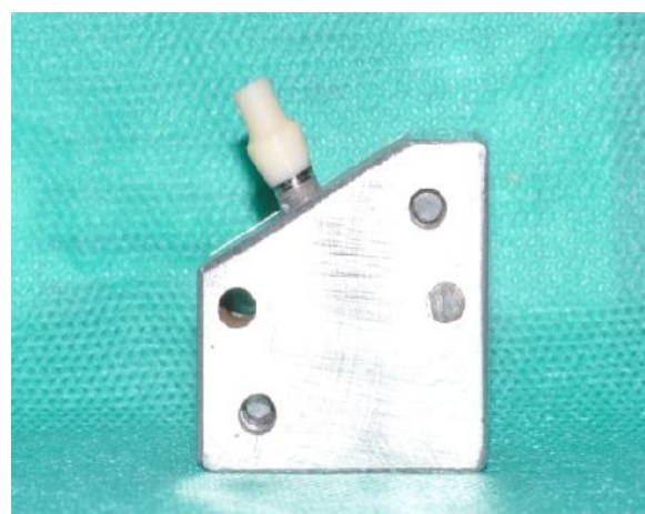
شکل ۲- مانت نمونه‌ها در جیگ اختصاصی با زاویه ۳۰ درجه
