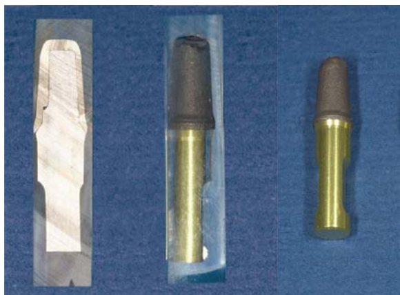
شکل ۵- از راست به چپ: فریم بر روی آنالوگ نشانده شده، در آکریل شفاف قرار داده، سپس برش داده شده است.
