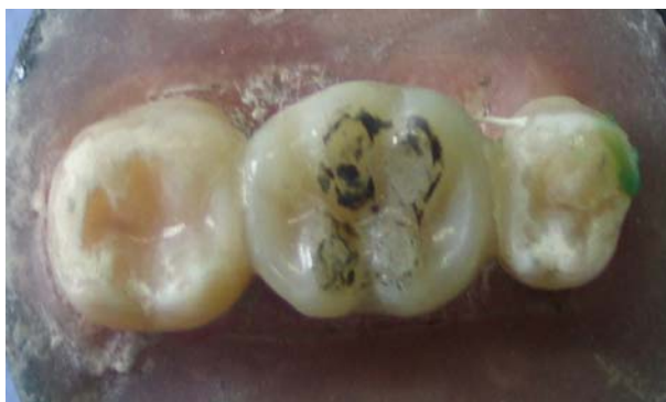
شکل ۸- سائیدگی سطح اکلوزال پونتیک اینله بریج خلفی پس از انجام عمل load cycling
