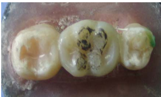
شکل ۸- ساییدگی سطح اکلوزال پونتیک اینله بریج خلفی پس از انجام عمل load cycling
