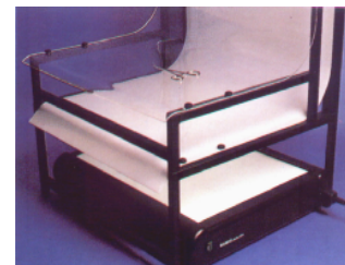
شکل ۲۲- a، اصول نورپردازی با نور عبوری (transmitted) b، نور عبوری و وسائل مربوطه (همراه لامپ‌های نور روز)
