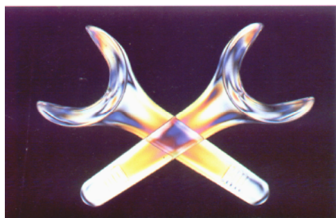
شکل ۲۳- عکسهای فتوالاستیک که توسط نور ترانس‌میتد تهیه شده است.
