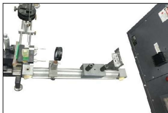
شکل ۲- چیدمان آزمایش حین پرتودهی
