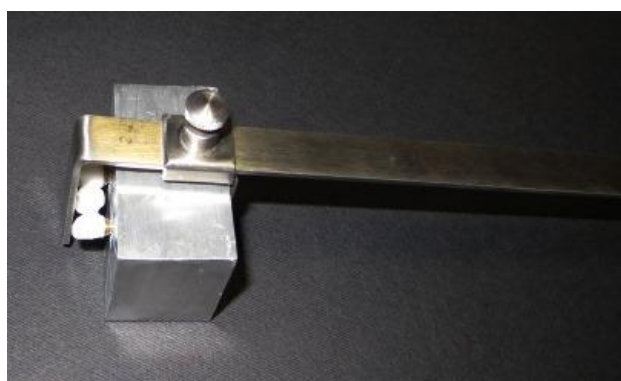
شکل ۳- کلمپ نگه دارنده فریم ورک بر روی مدل اصلی
