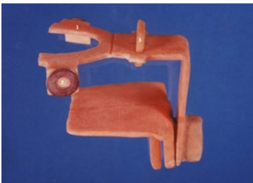
شکل ۲- قسمت متحرک دستگاه HPSI در اتصال با قسمت ثابت. شماره ۱: بایت پلیت، شماره ۲: صفحه حامل حلقه‌های فلزی، شماره ۳: صفحه‌ای مربع شکل حامل چهار سیم فلزی عمود به هم.
