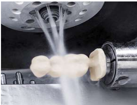
شکل ۹- تولید پروتزها با استفاده از ماشین فرز کنترل عددی را نشان می‌دهد. (الف) تولید اباتمنت اختصاصی، (ب) تولید روکش
