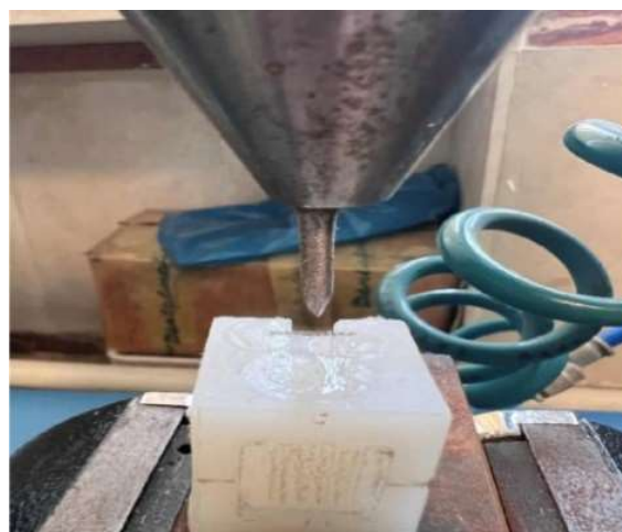
شکل ۴- اندازه گیری استحکام خمشی
