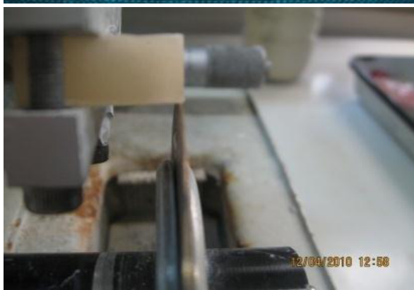
شکل ۱- صاف نمودن سطح ریج لب نمونه‌ها با استفاده از دستگاه برش
