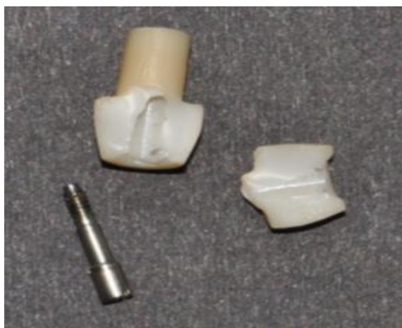
شکل ۳- شکست ناحیه اتصال در گروه Copy-milled
