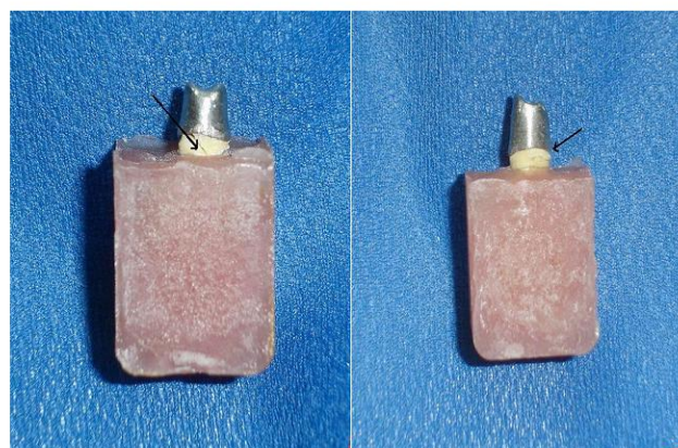
شکل ۴ - الف: شکست کور در گروه بدون فرول شکل ب: شکست مایل ریشه در گروه با فرول
