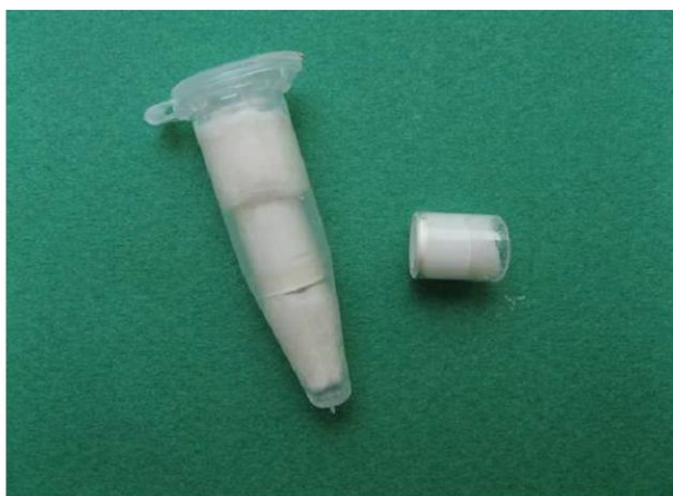
شکل ۱- قرار دادن پنبه مرطوب بر روی ماده داخل استوانه و انتقال به اپندروف
