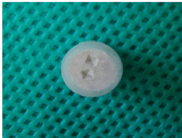
شکل ۴- اثر سنجه فرورونده (Indenter) بر سطح ماده
