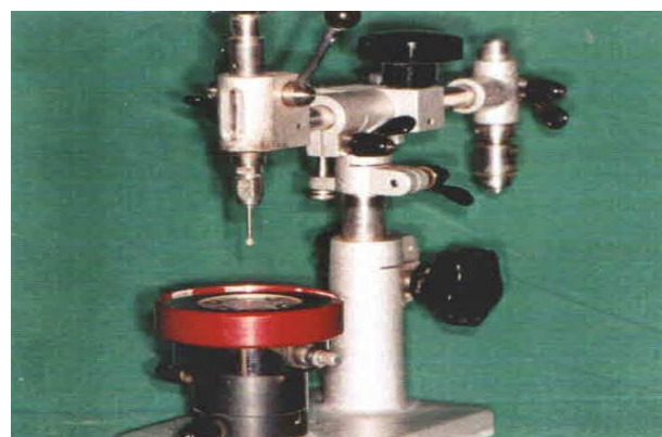
شکل ۲- دستگاه موازی‌ساز جهت پانچ نمونه‌ها
