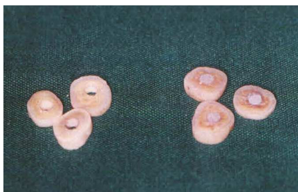
شکل ۱- قرص‌های عاجی پانچ شده (سمت چپ) و قرص‌های عاجی ترمیم شده (سمت راست)
