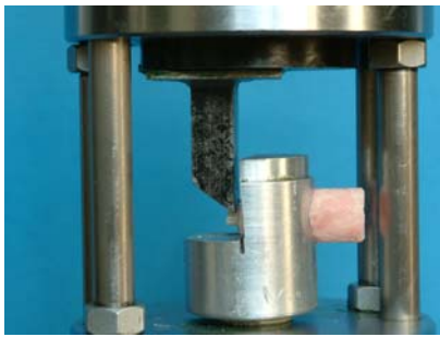
شکل ۲- نحوه ورود نیرو بر نمونه کامپوزیت- پرسن
