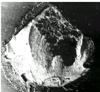
تصویر ۴- شکست Cohesive Resin در نمونه (Mag. x20) Gritblasted
