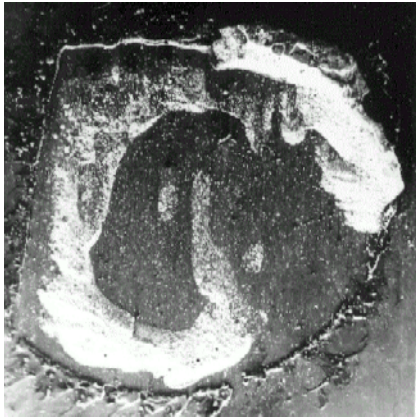
تصویر ۳- شکست Mixed Interface/Resin نمونه (Mag. x20) Polished
