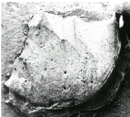
تصویر ۴- شکست Cohesive Resin در نمونه (Mag. x20) Gritblasted
