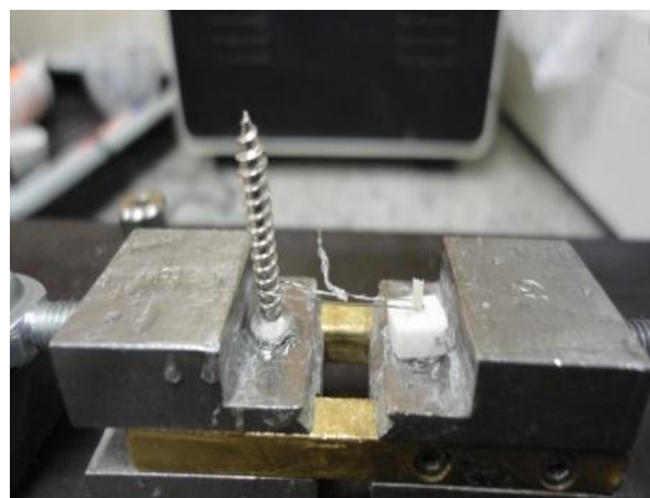
شکل ۴- حلقه در یک سو در دور استوانه کامپوزیتی قرار داده شد به نحوی که تقریباً با نیمی از محیط استوانه در تماس باشد
