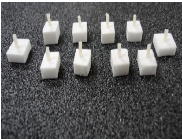
شکل ۳- استوانه‌های کامپوزیتی به سطح سرامیک باند شده است
