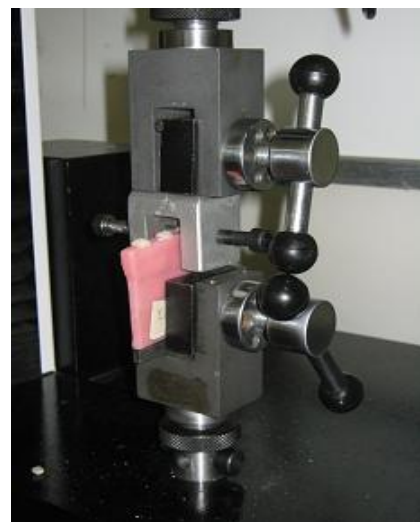
شکل ۱- تصاویر لوازم مورد نیاز برای آزمایش باندینگ توسط استاندارد
