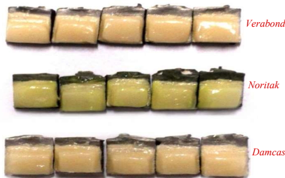
شکل ۴- رنگ پرسلن اعمال شده روی آلیاژهای مورد بررسی پس از انجام مرحله پخت نهایی (گلیز)
