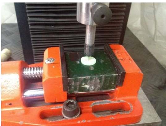
شکل ۱- قرارگیری نمونه‌ها در دستگاه تست یونیورسال
