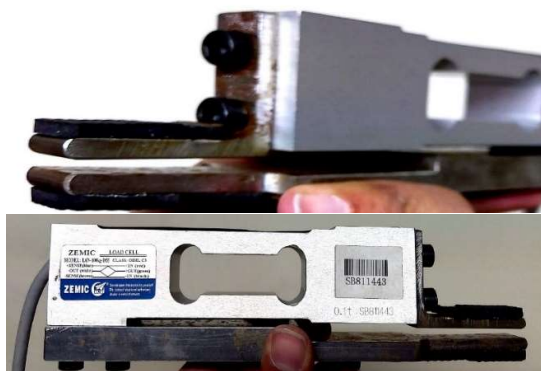
شکل ۱- دستگاه ثبت نیروی بایت
