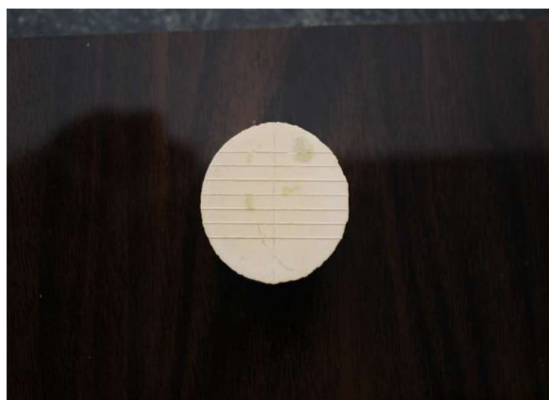
شکل ۲- نمونه گچی زیر دوربین از فاصله ۱۵ سانتی متری
