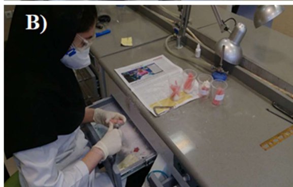
شکل ۵- استفاده از تریمر (A) و هندپیس (B) برای فینیش نمونه‌ها
