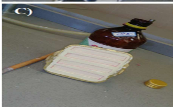
شکل ۳- مراحل مفل گذاری. قرار دادن الگو روی نیمه پایینی مفل (A) قرار دادن مفل زیر فشار (B) و آغشته کردن آن به بیوفیلم (C)
