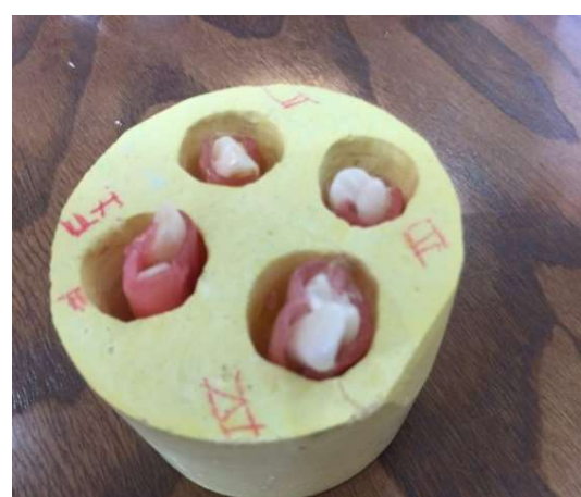
شکل ۱- بلوک استفاده شده در مطالعه (مخلوط گچ و اکریل) و چهار حفره مشابه برای قرارگیری هم زمان نمونه‌ها درون بلوک
