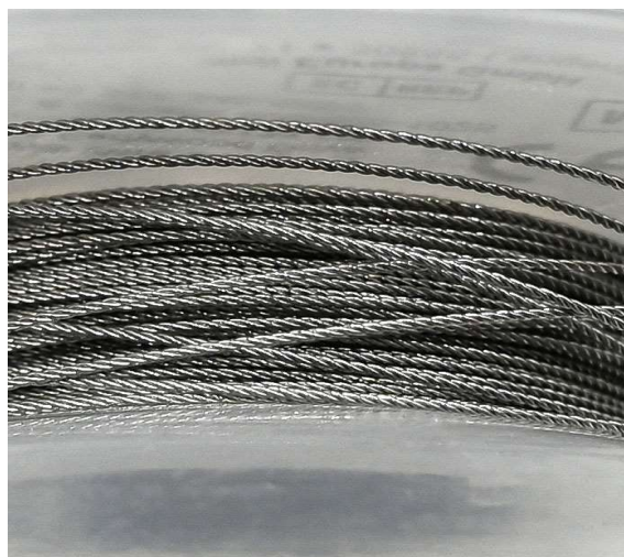
شکل ۱- 0/0175 stainless steel twisted wire
