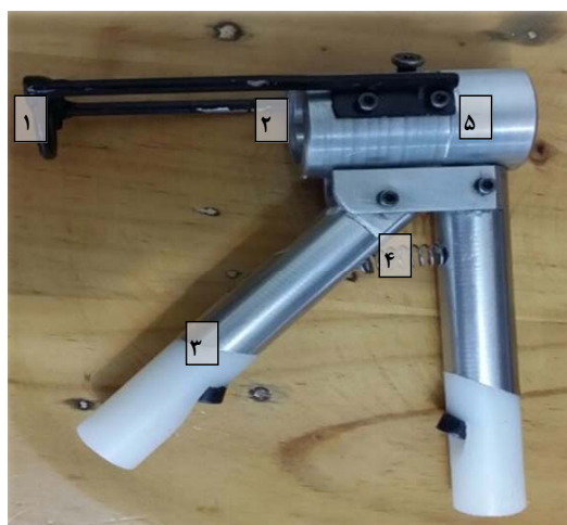
شکل ۳. پروتوتایپ ساخته شده دستگاه متصل کننده ست سرم. ۱: محل اتصال سرم، ۲: محل اتصال ست سرم، ۳: اهرم، ۴: فنر، ۵: بدنه اصلی دستگاه
