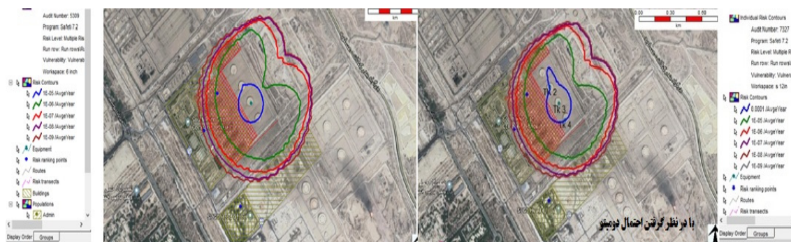
تصویر ۴. تراز ریسک فردی نشتی مخزن TK3 با و بدون در نظر گرفتن اثرات دومینو
