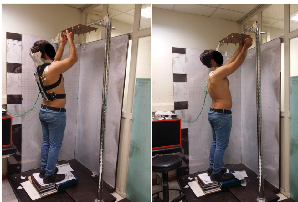
شکل ۲. انجام وظیفه در ارتفاع بالای سر، سمت راست بدون استفاده از اگزواسکتون، سمت چپ با استفاده از اگزواسکتون
