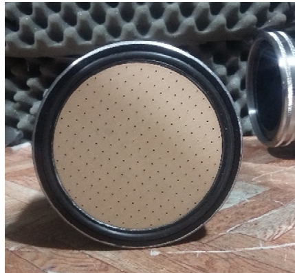
شکل ۳. تصویر نمونه‌های MPP ساخته‌شده از کامپوزیت PLA/Corkwood
