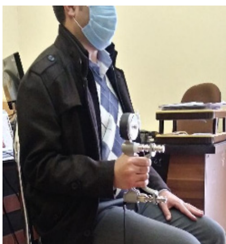
شکل ۲: پوسچر استاندارد برای ثبت نیروی چنگش آزمودنی‌ها
