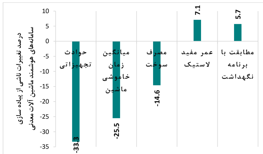
شکل ۳: میزان اثربخشی استفاده از سامانه‌های هوشمند ماشین آلات معدنی بر پارامترهای تعریف شده
